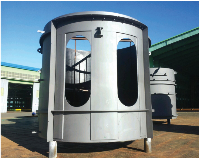
Duct for HRSG
