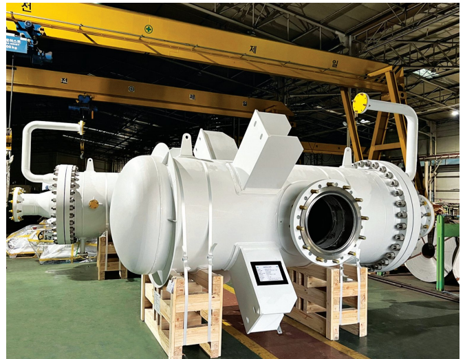
Suction Vessel for LNG Pump
